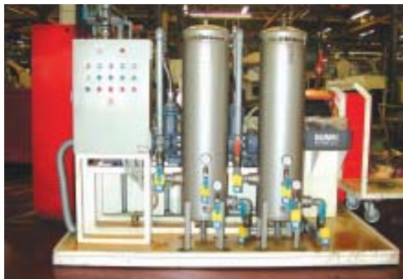
藤沢製作所の機械加工油ろ過システム
