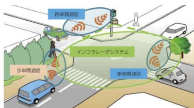
応用製品：ミリ波車車間通信 ミリ波通信にて車両間 で情報共有
